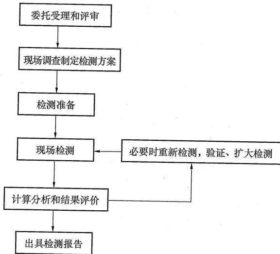
图 1 检测工作程序框图
