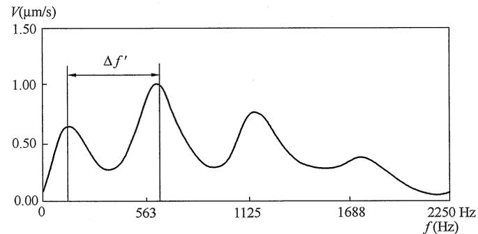
图 12.4.2-2 缺陷位置频域计算示意图
