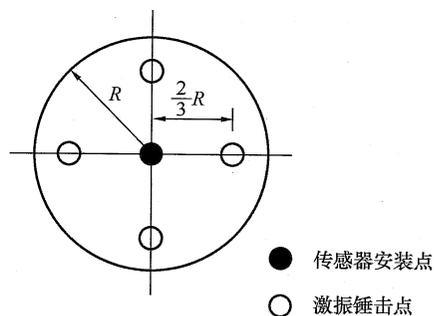
图 14 传感器安装点、锤击点布置示意图
